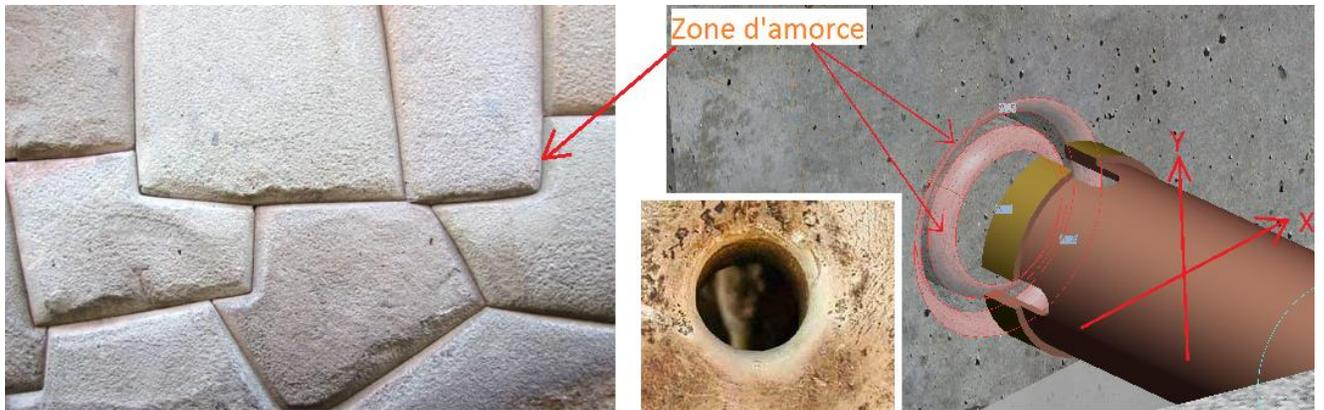
On retrouve l'éclatement de surface en perçant aussi de la matière dure comme la céramique ou du béton à haute résistance en particulier avec un outil électrique par impact ou par impact/rotation.
