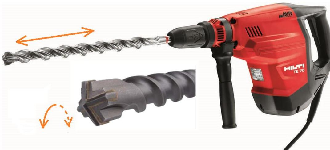
L'outil ci-haut présenté est un outil industriel très répandu en industrie. Bien qu'il et bidirectionnel, la forme hélicoïdale de l'outil permet dans la rotation vers la droite d'évacuer la poussière et les petits grains de matière coupée. L'outil présenté montre bien le concept de matrice Mole pouvant prendre la vibration et l'ajout de parties à haute dureté, dans ce cas-ci du carbure.
