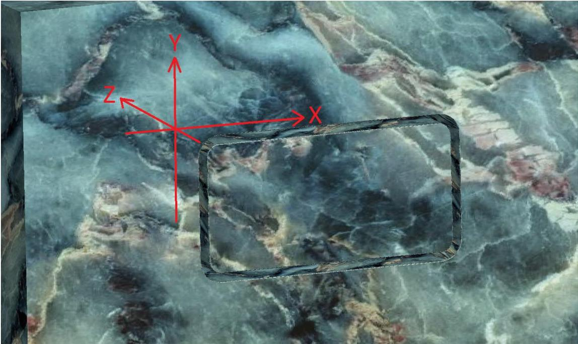
Pour effectuer une découpe comme montré ci-haut, on doit absolument amener l'outil de découpe à osciller sur le plan de découpe XY. On peut penser utiliser un mécanisme de vibration sur l'axe X jumelé à un autre mécanisme semblable pour l'axe Y, mais cela devient complexe pour rien.
