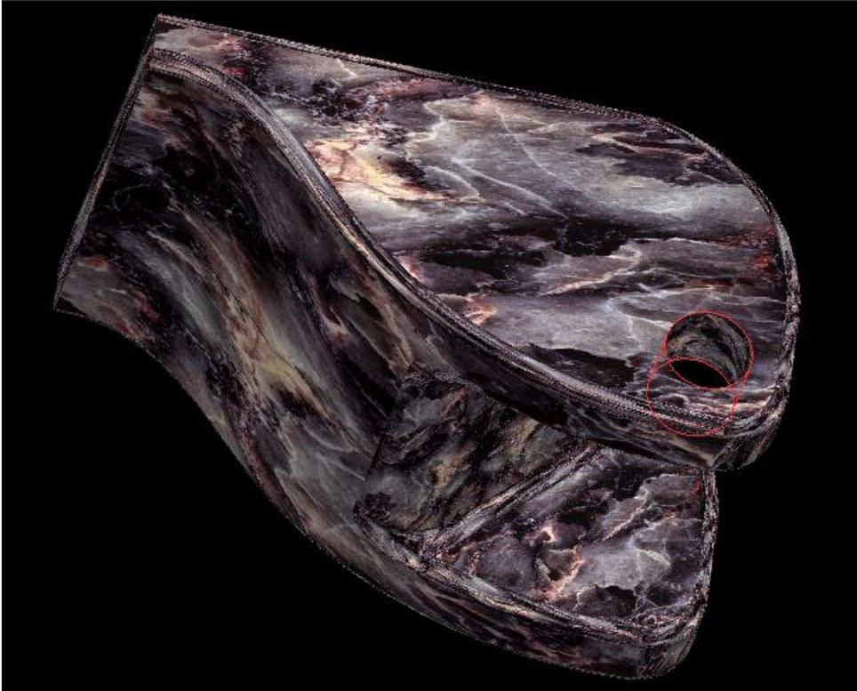
Une manière simple et efficace serait d'utiliser un moule de bois par exemple et de positionner la pièce à la vertical ou selon l'angle désiré pour la découpe dans un aggloméra de boue et de paille ou encore d'argile ou encore de cire. Une fois durci, l'aggloméra constitue une masse plus important et stable à percer. On minimise ainsi les problèmes de vibration qui peuvent causer la fissuration des pièces. Il en est de même pour la taille intérieure et extérieure de pots ou vases.
